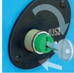
2. Introducir la llave de extracción (combinación "900") y girarla en sentido de las agujas del reloj. En las cerraduras standard se debe de asegurar el trinquete de manera que esté recogido hasta estar finalizado el cambio de cilindro.
