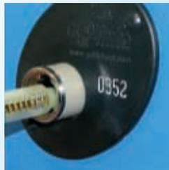
2. Introducir el nuevo cilindro haciendo coincidir la pestaña del último diente del cilindro con el encaje del alojamiento. Después, se puede soltar el trinquete (cerraduras standard).
