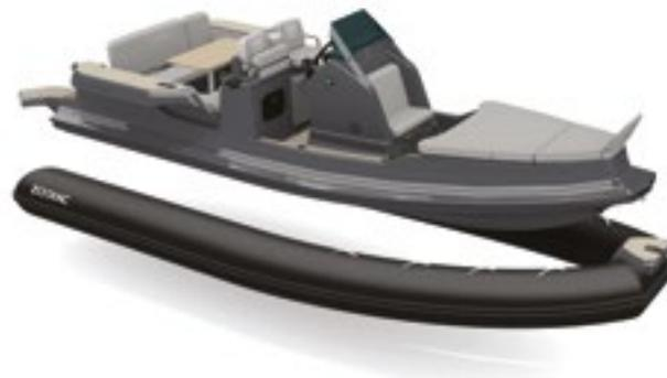
Disponible en la mayor parte de sus modelos, el flotador está equipado con una relinga que se encaja en un raíl hecho en el casco. La impermeabilidad está asegurada por la propia presión del flotador.
